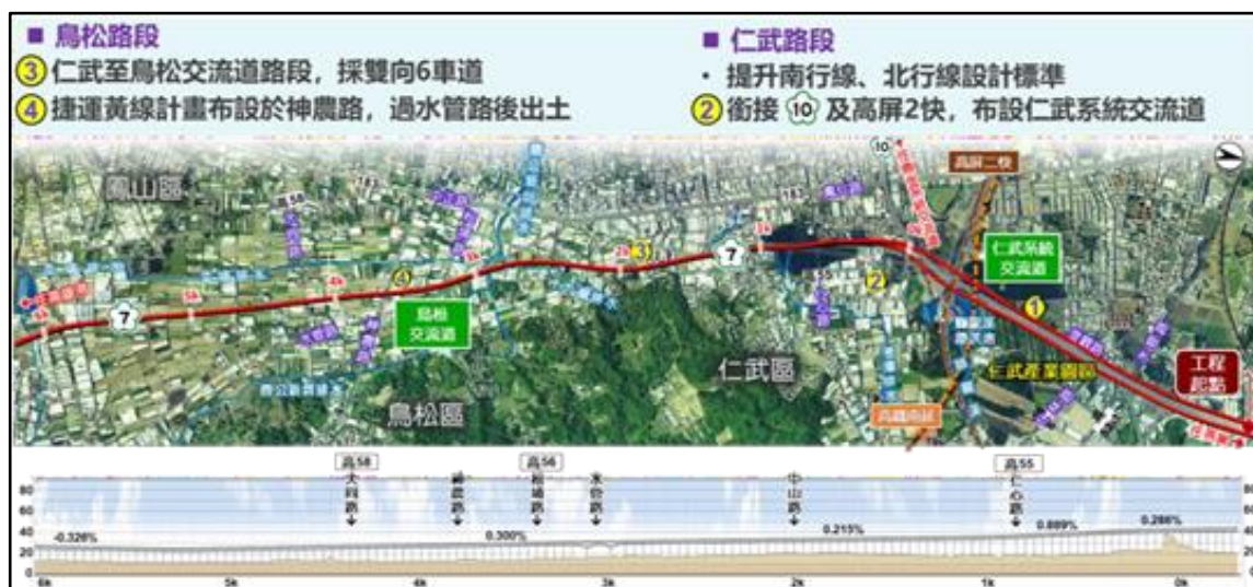
圖 7-6 鳥松、仁武路段平縱面路線布設示意圖
