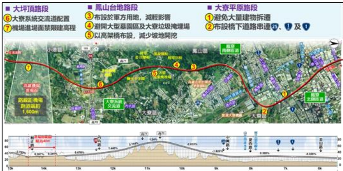
圖 7-7 大坪頂、大寮鳳山路段平縱面路線布設示意圖
