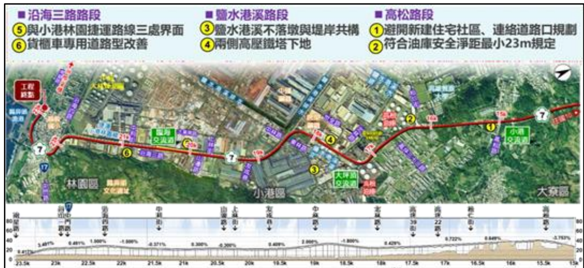
圖 7-9 臨海工業區、大坪頂路段平縱面路線布設示意圖
