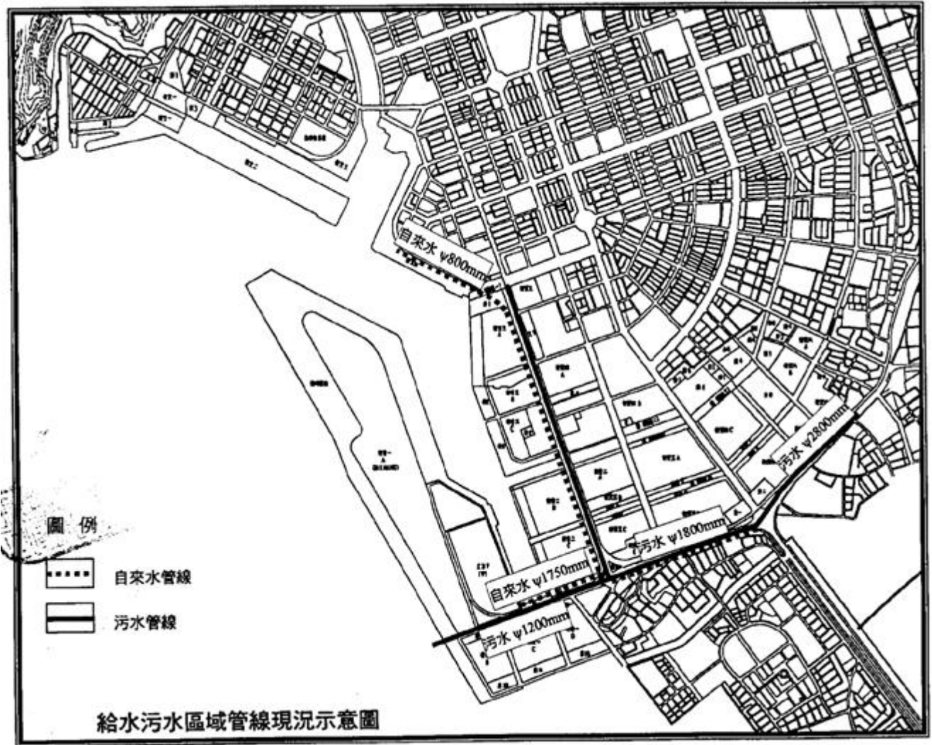
圖5-5 給水污水區域管線現況示意圖
